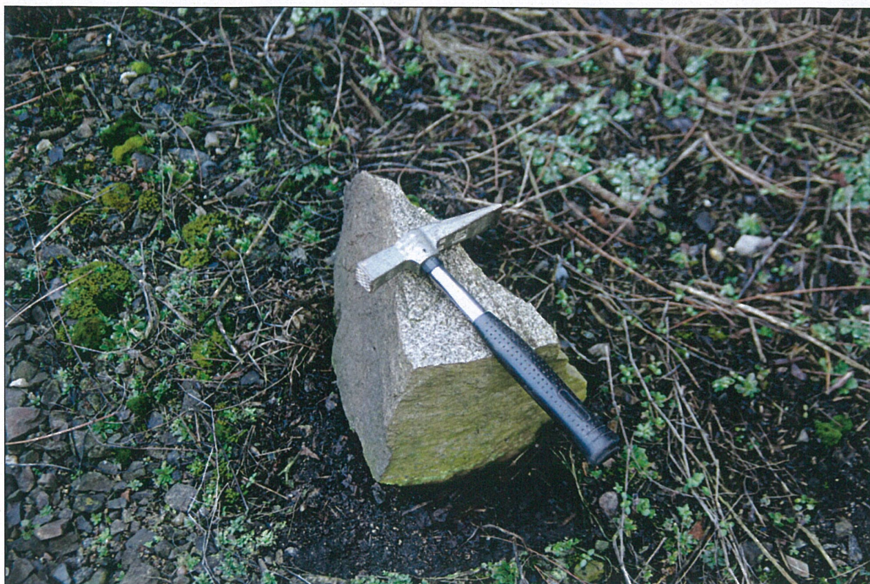
Foto – 9 Pohled na vypadlý fragment žuly ze stěny odkryvu v km 300,890.
